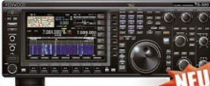
Die Kombination von Down-Conversion-RX und IF-Direct-Sampling-Bandscope verspricht beste DX-Leistung.
